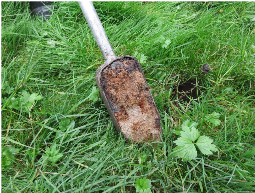
Figuur 12 Bij de grondboring die we uitvoeren in het voorland komen we al snel zand tegen.
