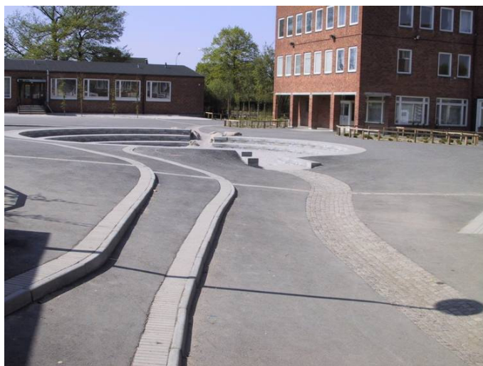
Figuur 8.3. Amfitheater op schoolplein in Malmö dat ook dient voor de berging van regenwater.
